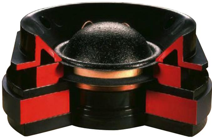
Der 3-Zoll-Mitteltöner gehört zu den größten Kalotten überhaupt. Seine 76-mm-Schwingspule wird von einem riesigen Magneten in Bewegung versetzt, die Gewebemembran ist weich und sehr großzügig mit dämpfendem Spezialmaterial getränkt.
